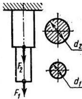
Для материала бруса (сталь Ст3) принять  $[\sigma_c] = 160 \text{ МПа}$ ,  $[\sigma_p] = 120 \text{ МПа}$ .
